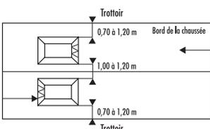
Ralentit le trafic automobile, camionnettes et camions sans gêner la circulation des bus. Caoutchouc vulcanisé coloris rouge (coloris noir nous consulter). Bandes rétro réfléchissantes blanches avant et arrière. Dimensions totales : long. 300 x larg. 180 x haut. 6,5 cm. Dimensions d'un élément : long. 100 x larg. 90 x haut. 6,5 cm.
