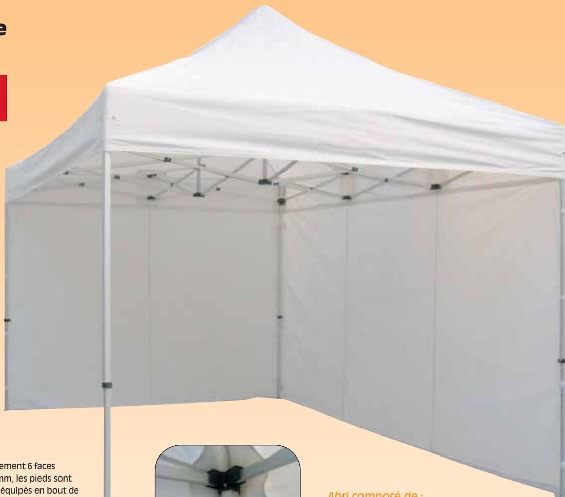
**Structure :** aluminium anodisé, piétement 6 faces Ø 40 mm, croisillon section 26 x 13 mm, les pieds sont réglables (hauteur de 180 à 210 cm) équipés en bout de triangulaire et au centre du toit, un mât télescopique avec ressort de tension.
