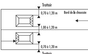
Ralentit le trafic automobile, camionnettes et camions sans gêner la circulation des bus. Caoutchouc vulcanisé colorisé rouge (coloris noir nous consulter). Bandes rétro réfléchissantes blanches avant et arrière. Dimensions totales : long. 300 x larg. 180 x haut. 6,5 cm. Dimensions d'un élément : long. 100 x larg. 90 x haut. 6,5 cm.
