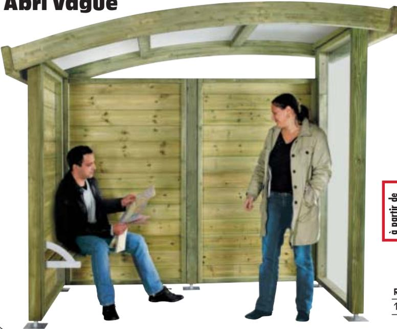
Structure : Pin traité autoclave classe IV. Poutres cintrées en lamellé collé classe III. Poteaux 90 x 90 mm avec sabots galvanisés. Visserie inox.
